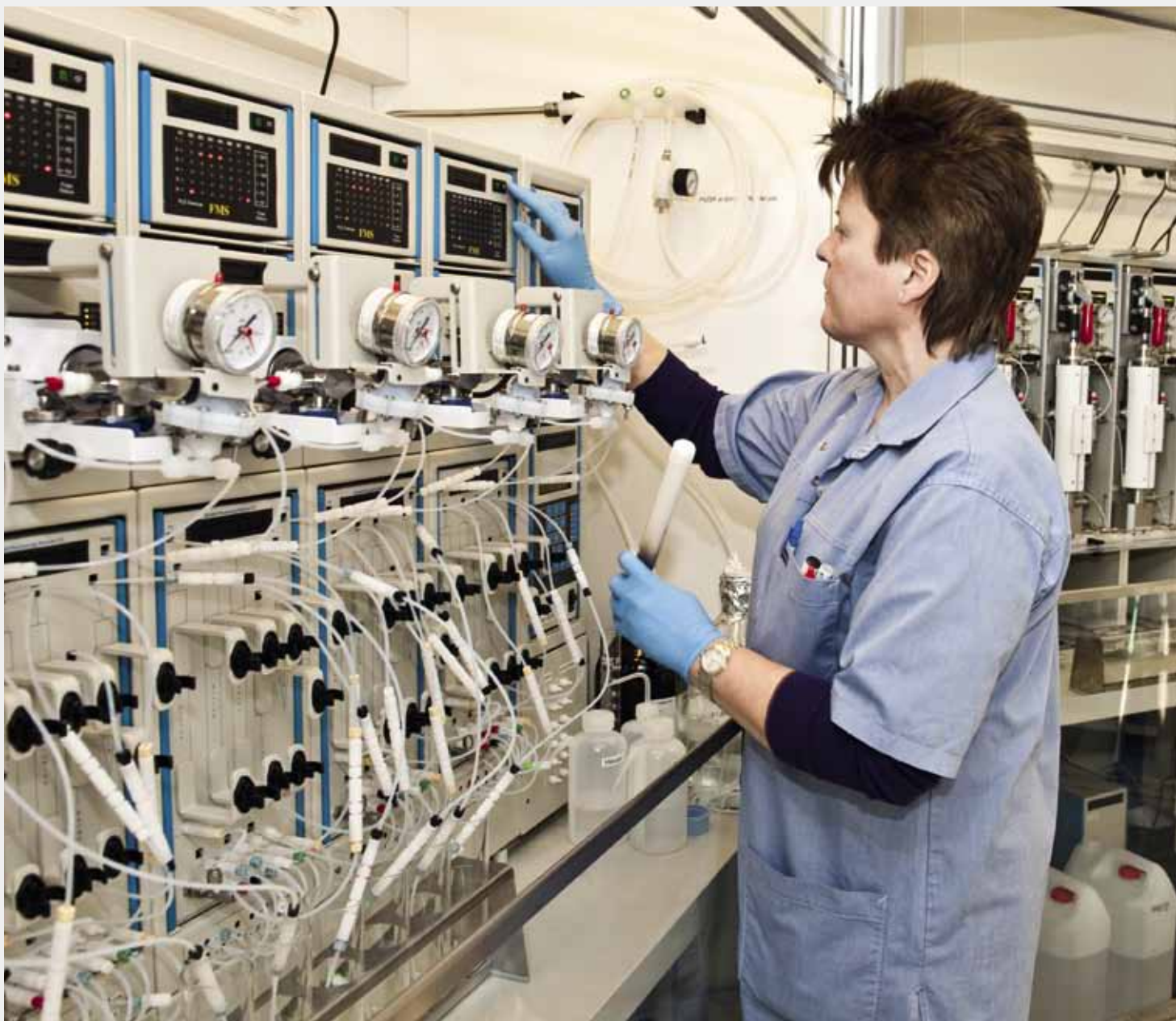
De to første trin af dioxinanalysen i det udvidede laboratorium. På apparaturet i baggrunden udvindes fedtindholdet i fiskemelet ved ekstraktion. Denne fedtfase, hvori dioxinerne er bundet, skal igennem næste trin, som Ellen Nørgård her er i gang med. Resultatet er en prøvemængde på kun 20 mikroliter, som dioxinerne er opløst i. Prøven er herefter klar til DFS'en med slutanalysen på billedet på forrige side.
